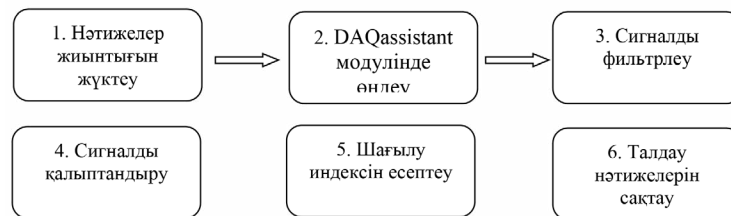
2-сурет – Шағылу индексі сигналы мен есептеудің блок-сұлбасы
